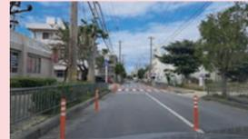
ポストコーンの設置は、道幅を狭くして、スピードを減少させる効果がある。
