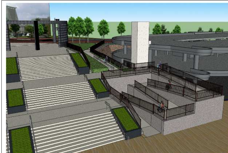
【車いす使用者等のためのスロープ及びエレベーター】
