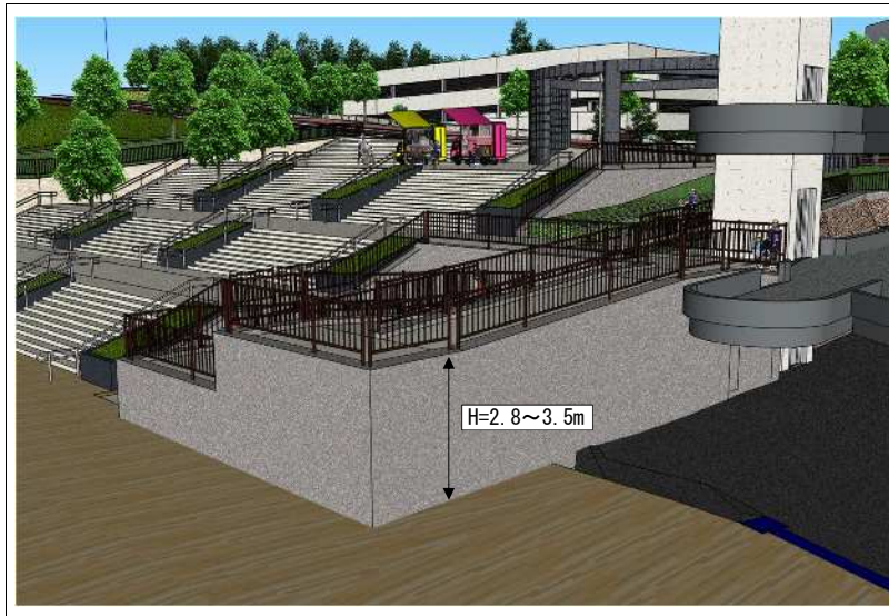
【エレベーターの利用状況及び階段工に伴う新設擁壁】
