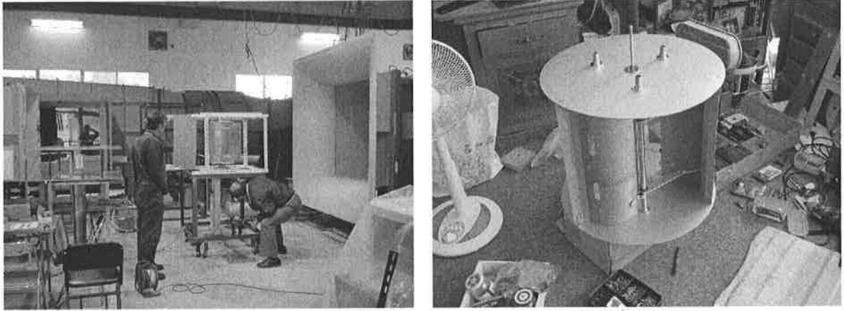
図1の左側風車のサボニウス型を琉大の風洞実験室でトルク測定を伊良部先生に実施して戴きましたがトルクが少ない為に更に効率を上げた仕組みを盛り込んだものが右側の写真です。
