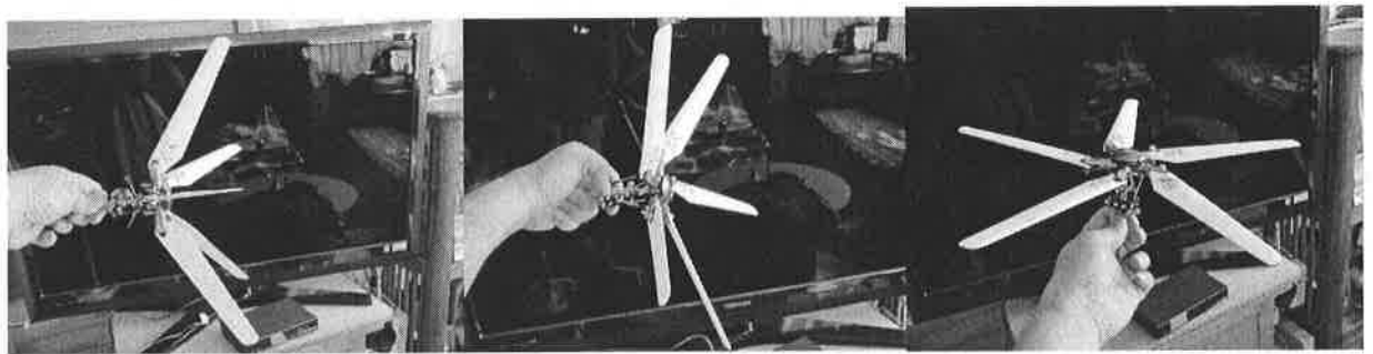
図1の右側、双子風車の羽根の部分ですが、写真の一番左側が台風のような強風、右側が微風の時に羽根を一杯に広げてエネルギーを沢山受けます、写真の真中がある程度の強風用です。
