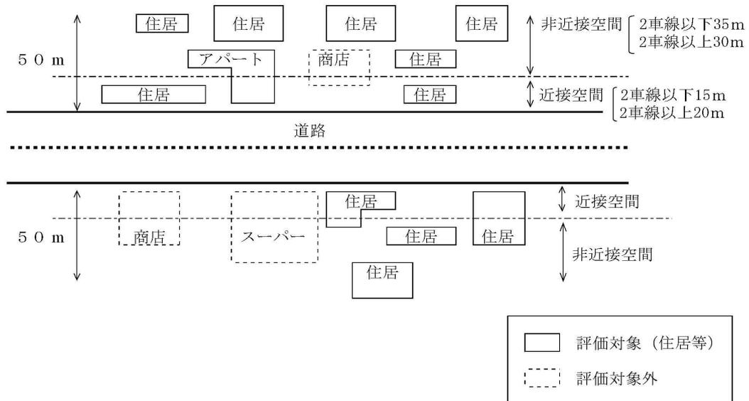
面的評価は道路端から50メートルにある住居等を対象とし、評価区間は、自動車の運行に伴う騒音が概ね一定とみなせる区間に分割します。
