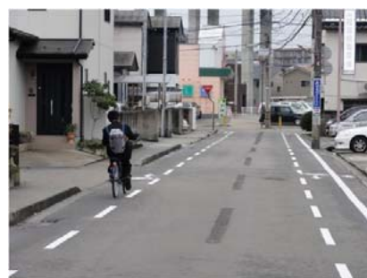
写真 2 車道左側部の車線内に帯状の路面表示を設置した事例
