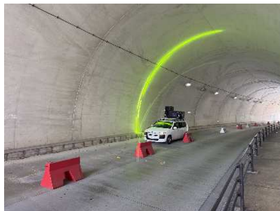
写真 8-2. 画像取得状況 （前田トンネル）
