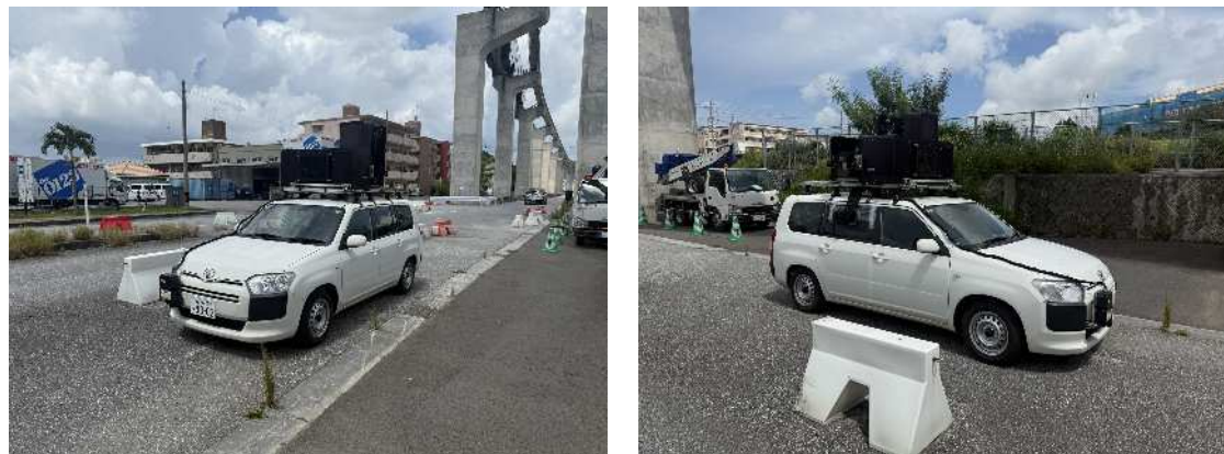
写真 8-1. 画像計測車両
