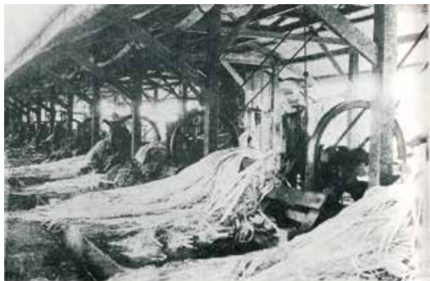
写真 17 ハゴタンを使いアバカの皮から繊維をとりだしている Removing the fibers from the bark of the abaca using a portable stripping machine (hagotan)
