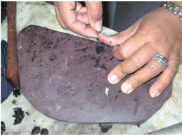
樹脂型及び成型したラック・ティライの型抜き (38頁) ータイ・タイ文化省芸術局伝統技術部ー
